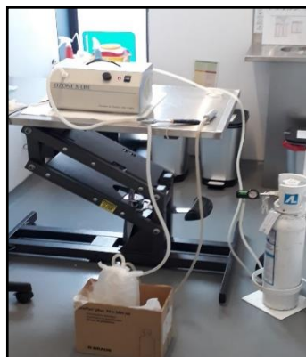
Figura 9 – Procedimento de ozonização: aparelho, oxigénio medicinal e proveta com óleo de girassol a ser ozonado; e respetiva tabela para acerto do fluxo de ozono (fotografias do aluno).
