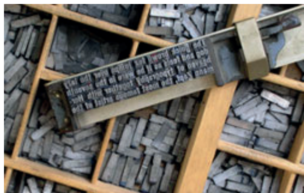
Figura 67: Tipo móvel de impressão da Europa inventado por Johannes Gutenberg Fonte: https://sfbook.com/the-evolution-of-the-book.htm
