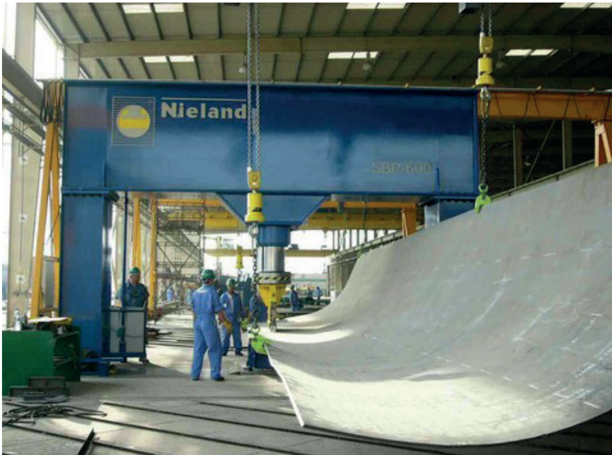
Figura 161: Prensa hidráulica (Shipbuildingpress - SBP) da Nieland
