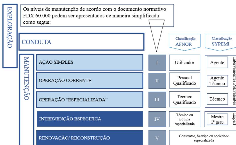
Figura 3 – Níveis de Intervenção de Manutenção [adaptado de: Norma AFNOR FDX60-000 (2002)]
