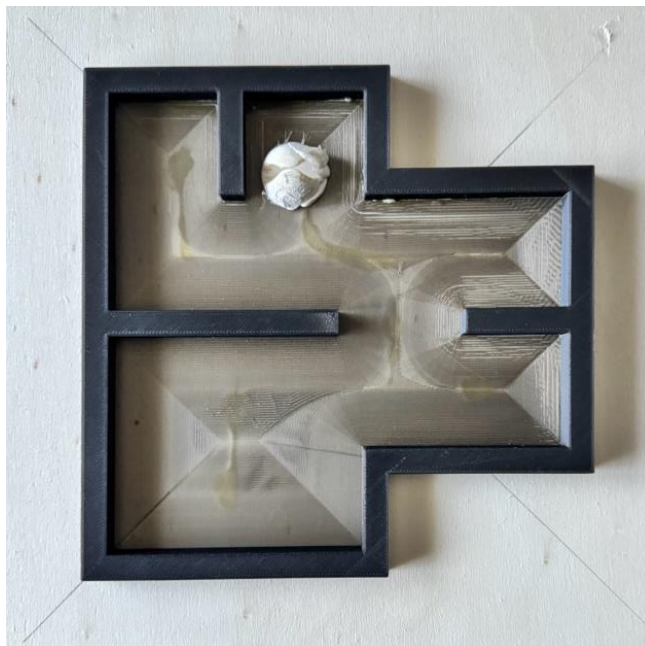
Figura 6 – Imagem do espaço difícil impresso em 3D
