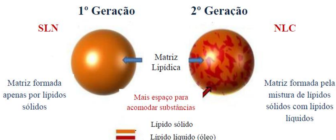
Figura 16 - Diferenças entre a matriz das SLN e dos NLC, adaptado de (Souto & Müller, 2010).
